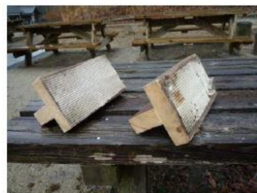
右:裏面に滑り止めを付ける)
