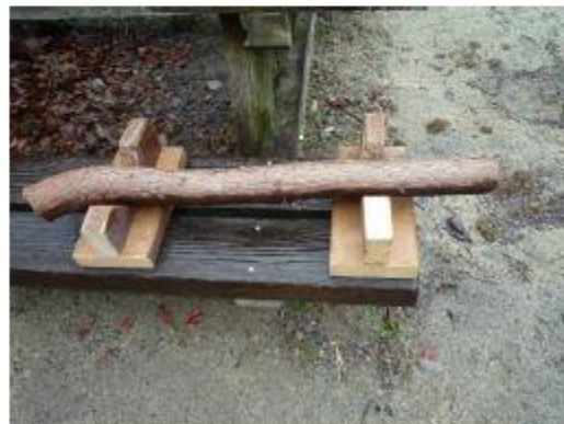
④ 簡易型の馬に丸太を載せたところ
